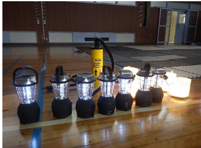
LED 照明(電池、太陽光を利用) 全部で25個あります
